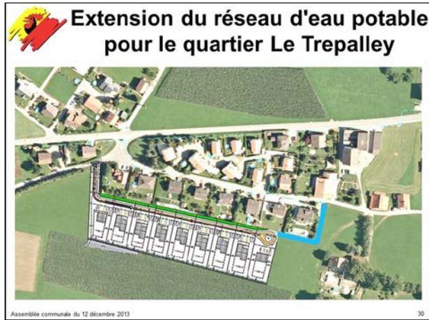
*La conduite principale, où va se faire le raccordement, se situe le long de la route du Clos d'Illens. La longueur du nouveau tronçon sera de 85 mètres. Quant à la conduite, elle sera en fonte "ductile ecopur" d'un diamètre de 125 mm. Une vanne principale sera installée afin de permettre la fermeture totale de ce nouveau tronçon d'eau potable.*
