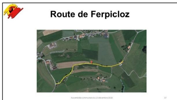
Concernant la route de Ferpicloz, il s'agit du tronçon partant de la croisée de la route d'Arconciel et se terminant la laiterie de Senèdes (environ 1000 mètres). Les travaux prévus sont une réfection complète du coffre en le stabilisant avec du ciment, puis la pose d'une couche d'enrobé ACT16. Il est prévu de faire quelques places d'évitements sur le tracé.
