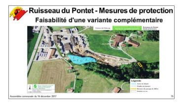
En fait, le pont sous la route à l'altitude 825 m est reconstruit et agrandi permettant le passage des matériaux de charriage et la zone de dépôt à l'altitude 810 m est également agrandi.
