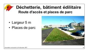
La route d'accès se fera entre la route cantonale et la pétanque. Le gabarit de roulement de la route d'accès est de 5 m. de largeur. Cet accès est revêtu en enrobé bitumineux. La route débouche sur la route de la Perrausa qui est une route communale. Le projet comprend également des places de parcs
