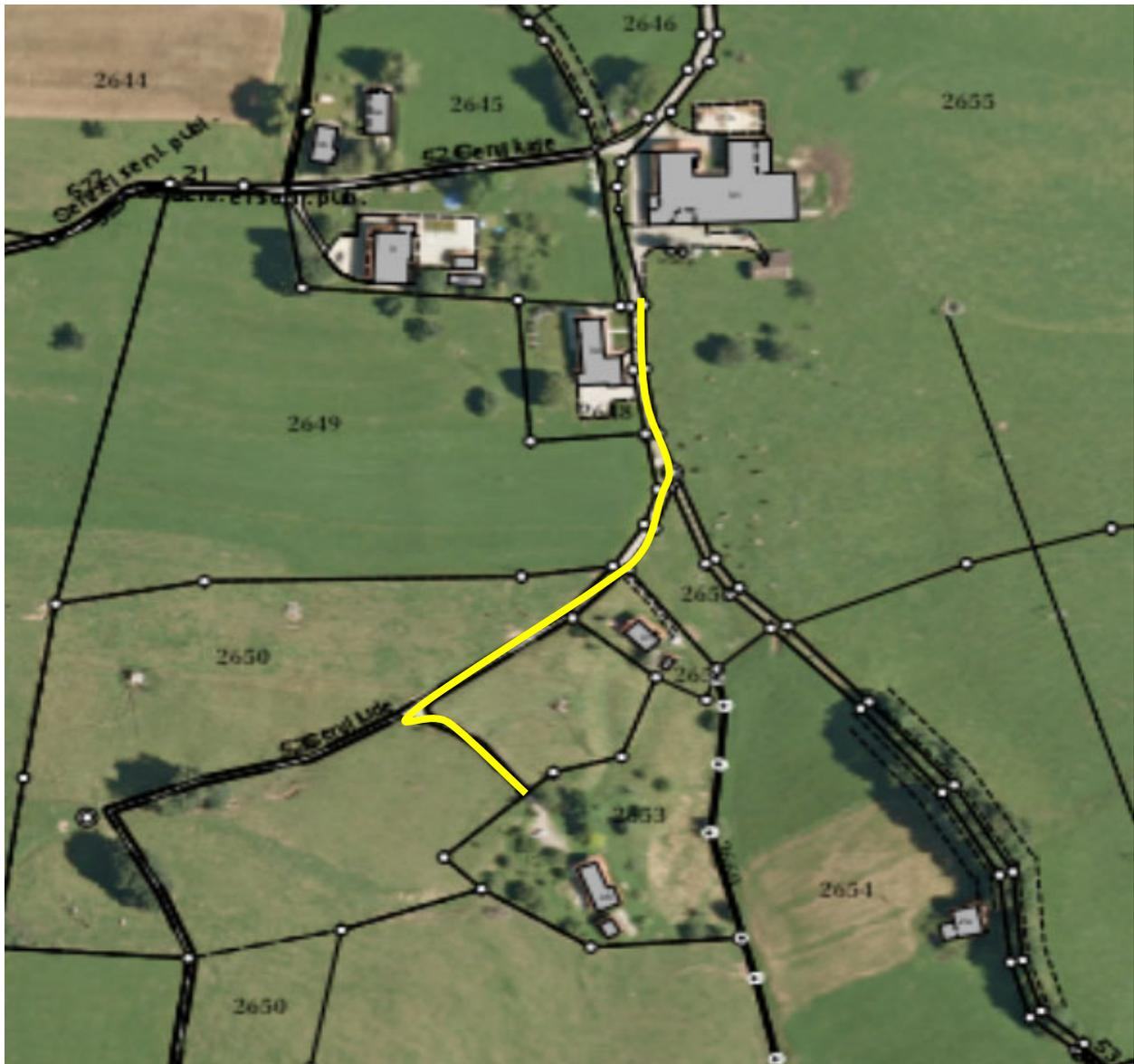
Les travaux prévus sont une réfection complète du coffre en le stabilisant au ciment et la pose au-dessus d'un enrobé bitumineux ACT 16. Une correction du dévers sera effectuée. Les canalisations ont été contrôlées. Celles-ci étant bonnes, leur remplacement n'est pas jugé nécessaire.
