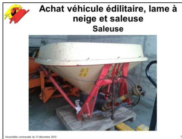
La saleuse actuellement en service présente également des signes avancés de vieillesse. Le système de distribution du sel est entièrement rouillé et ne va pas résister encore longtemps.
